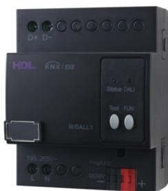
**HDL-M/DALI.1** HDL KNX DALI модуль с возможностью подключения до 64 DALI устройств для управления и адресации. В реальном времени может определять ошибки устройств, таких как DALI, ошибка лампы, ошибка балласта. Для каждого канала или группы поддерживается выключение вкл/откл, относительное диммирование, абсолютное диммирование, функции одно-байтных и однобитных ответов. Поддерживает стандартные кривые диммирования KNX и DALI.
